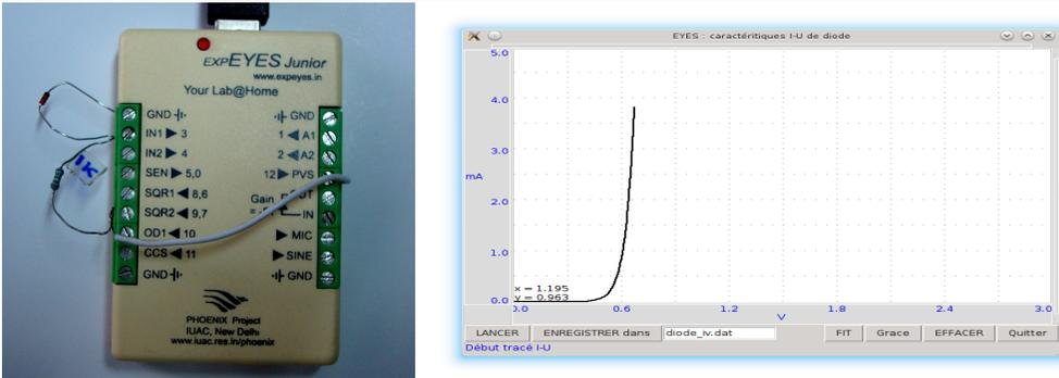
On connecte l'anode à la source de tension programmable (PVS) à travers une résistance de 1kOhm et la cathode à la masse (GND). PVS est modifiée progressivement et la tension aux bornes de la diode est mesurée, afin de tracer la courbe U-I.
